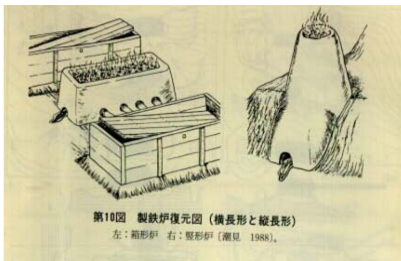
図 古代製鉄炉推定 箱型炉と竪型炉
