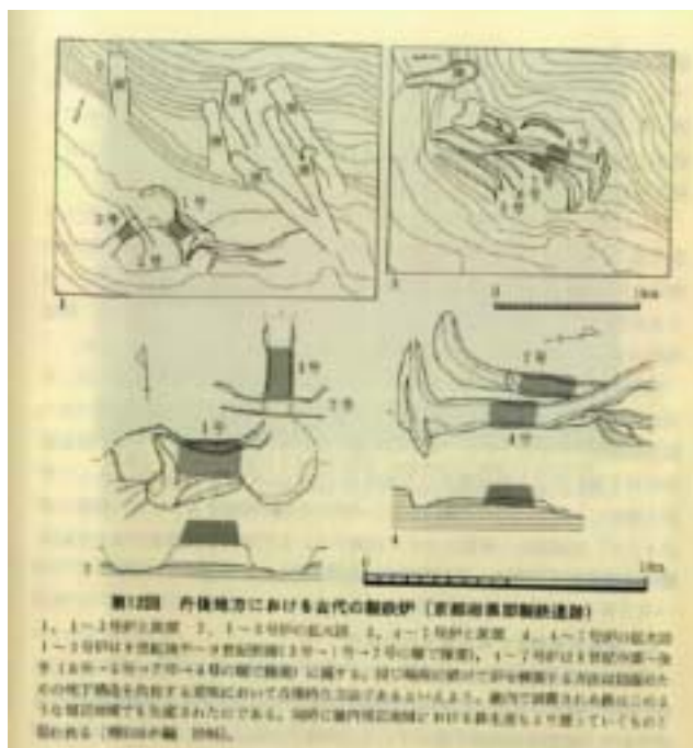
黒部遺跡で見つかった 「下部構造有り(左)・無し(右)」 両タイプの製鉄炉
