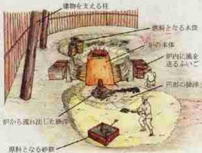
中世の製鉄炉 操業時の想像復元図
