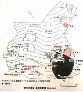
遺跡の中央南部で鍛冶工房1・2 北西部で鍛冶工房3・4歩か、最終的に全体で5軒の工房を確認。工房は斜面を平坦に造成した加工段に鍛冶炉を設ける構造。2基の炭窯1・2には多量の本炭が残存。豊際には分厚い焼土の堆積があった。鍛冶工房1・2の斜面下方の排滓場から鉄製工具・フイゴ羽口・砥石・鉄滓などとともに須恵器・土師器が出土。時代が特定された。
