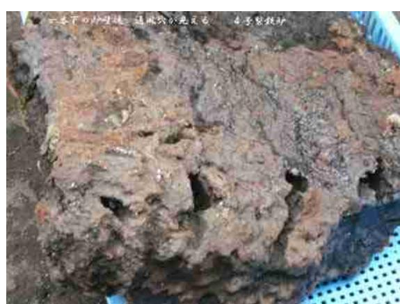
4号製鉄炉の炉壁端 通気穴が見える
