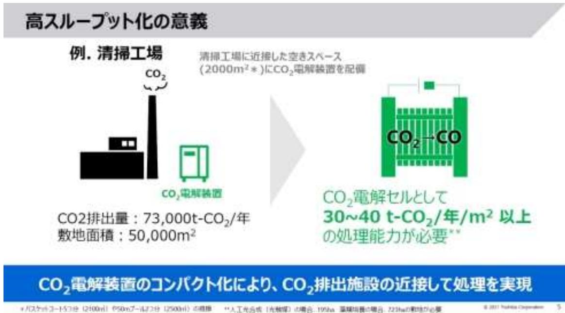
一般的な清掃工場の CO<sub>2</sub> 排出量に求められる CO<sub>2</sub> 電解装置の性能と設置面積 (クリックで拡大) 出典：東芝
