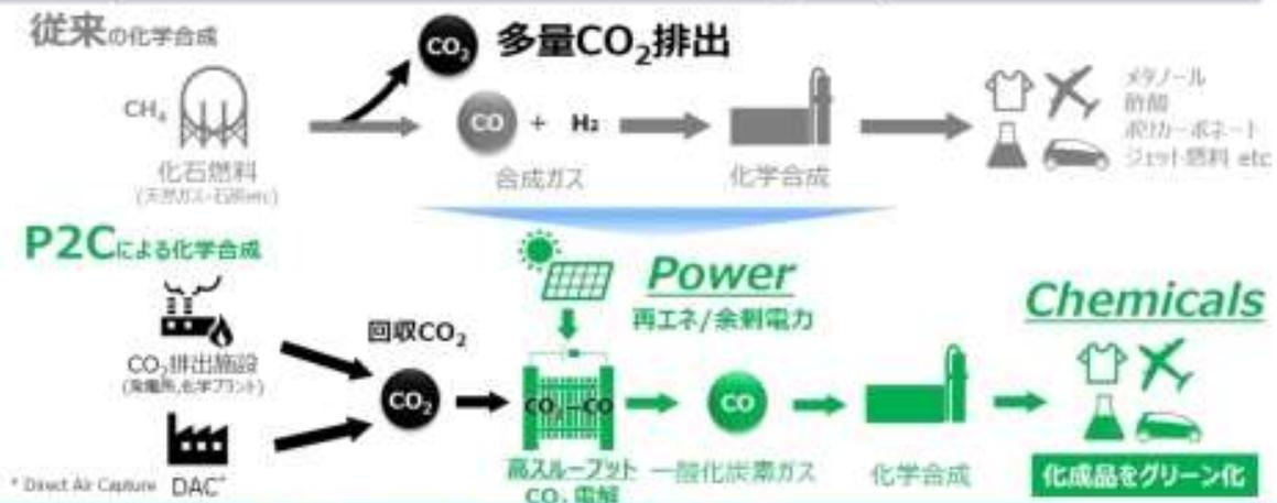
回収CO<sub>2</sub>と再エネ/余剰電力(Power)からCO等の化学原料(Chemicals)を製造し化成品をグリーン化
