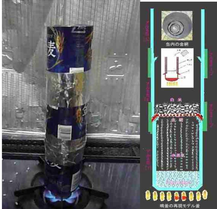
アルミ缶で製作した「鳴釜」モデル釜
