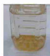
沸らせて2日 静置すると鉄分が沈殿して透明水に
