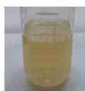
移し変えたり、車で揺られたり、帰り着いたときには鉄分が酸化析出して褐色に
