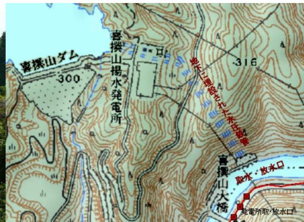
旺盛な電力需要をカバーするための大型水力発電所の建設が待たなしの時代。ダム湖から高落差の水圧鉄管を通して水を落として水車を回して発電する大型発電所。その水圧鉄管には極めて高い水圧と水衝撃が加わるので、その材料となる鋼板には厚肉で高い強度と靱性そして 大型構造物建設の技術としての溶接の容易さが要求された。
