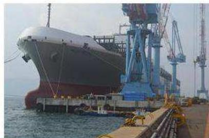
今治造船な島工場で建造されている約 1 万 4000 個積みの大型コンテナ船。来年にはさらに大きい 2 万個積みがつくれる超巨大ドックを新設する
